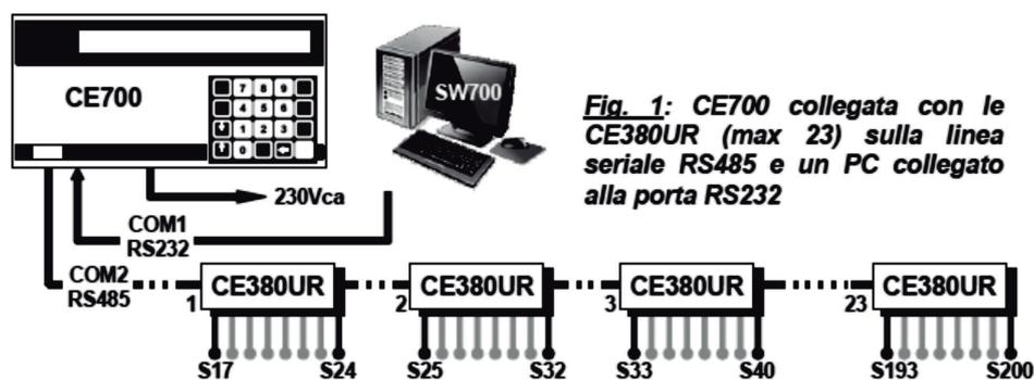
**Fig. 1:** CE700 collegata con le CE380UR (max 23) sulla linea seriale RS485 e un PC collegato alla porta RS232
